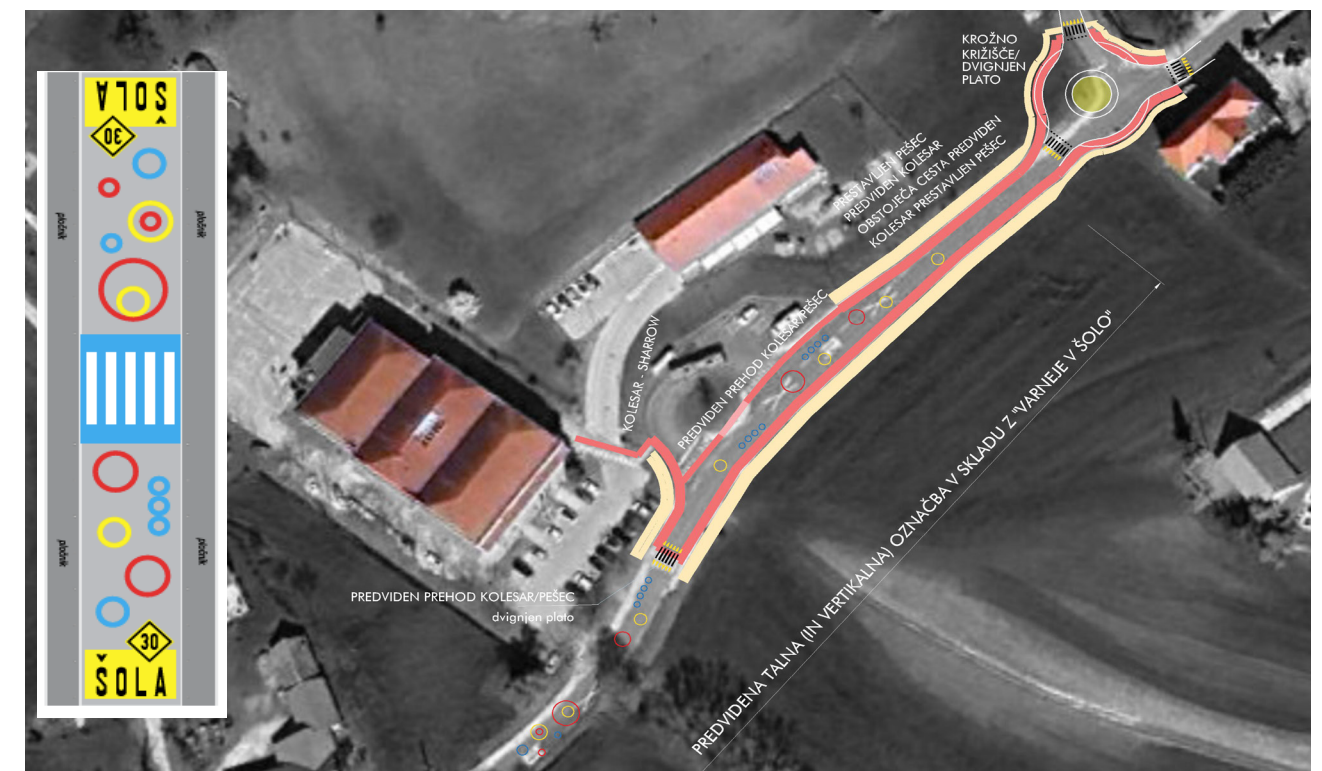
Slika 16: Predlog ureditve cestnega odseka med občinsko stavbo in Osnovno šolo Žetale - obstoječe križišče pred občinsko stavbo se preuredi v krožišče, ob cesti se vzpostavi dvosmerna kolesarska steza, hodnik za pešce se postavi na zunanji rob kolesarske steze ob zelenico, dodatno se lahko namesti dvignjeni plato na prehodu za pešce pred šolo in dodajo tudi vertikalne in horizontalne označbe.
